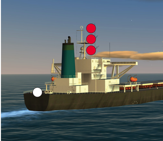
1.3.9. — Navire handicapé par son tirant d'eau - Les trois feux rouges verticaux, visibles sur tout l'horizon, sont facultatifs ; la marque de jour est également facultative (Règle 28).
