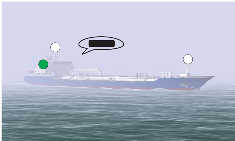
1.4.4.A. — Navire à propulsion mécanique faisant route avec erre (Règle 35 a).
