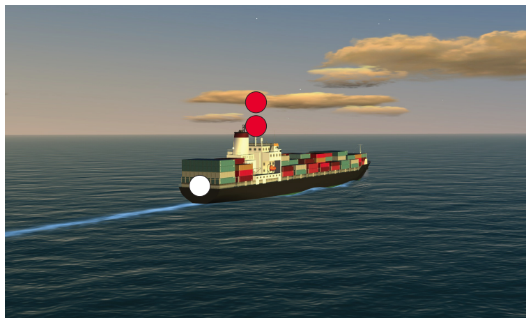
1.3.8.D. — Navire non maître de sa manœuvre avec erre vu de l'arrière (Règles 27 a-i et 27 a-iii).
