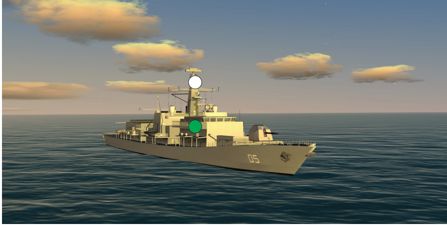
1.3.4.E. — Navire de guerre de longueur supérieure ou égale à 50 m ne portant qu'un feu blanc de mât.
