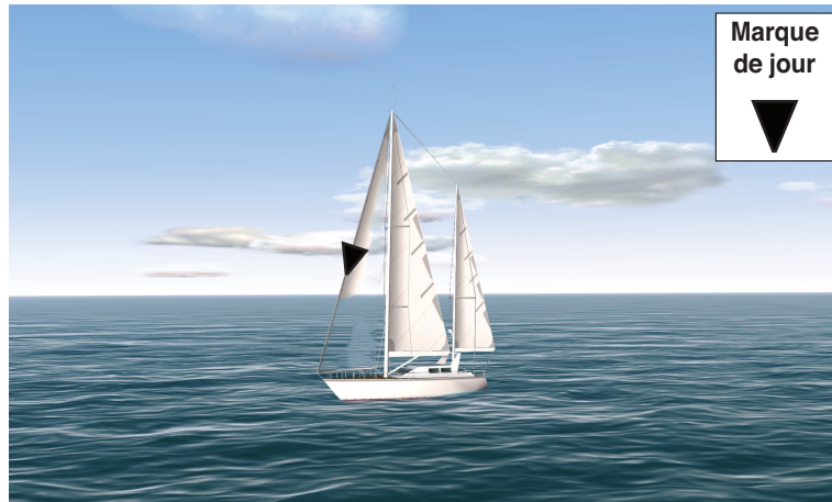
1.3.6.E. — Marque de jour d'un navire faisant route à la voile et au moteur.
