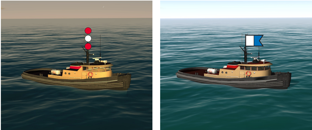
1.3.8.N. — Navires participant à des opérations de plongée (Règles 27 e-i et 27 e-ii).
