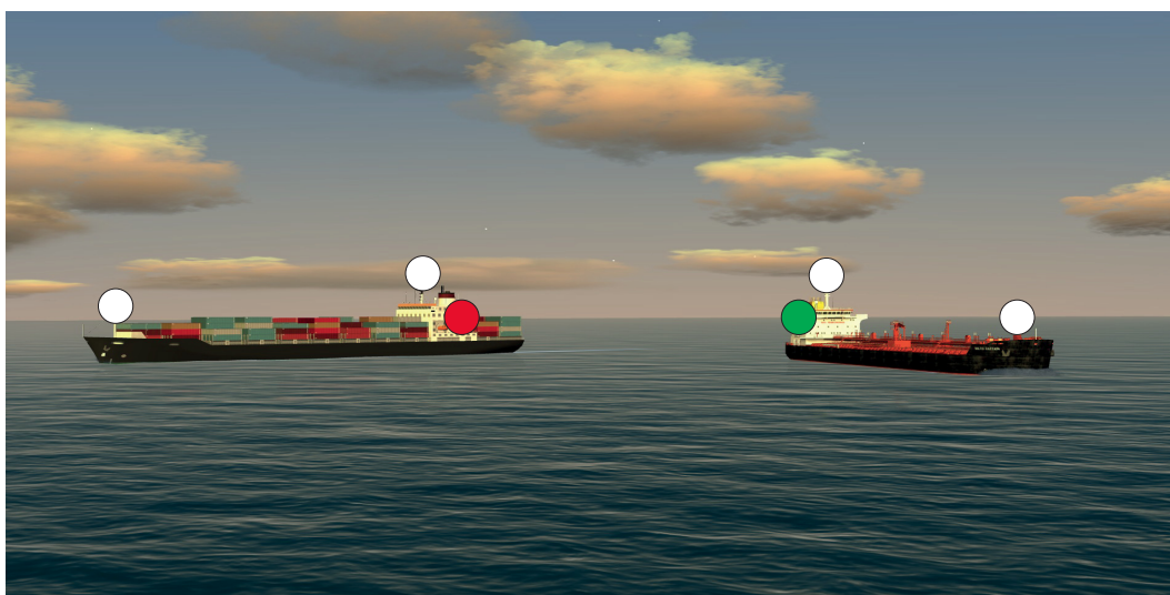
1.3.4.B. — Feux de tête de mât et feux de côté de navires faisant route (Règle 23 a).
