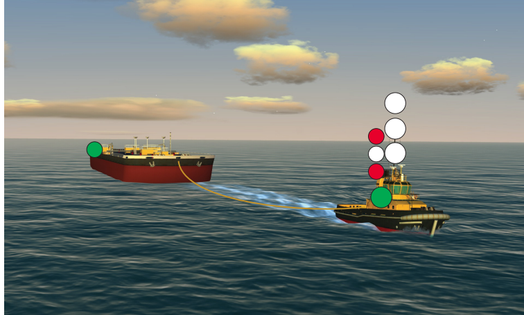
1.3.8.I. — Navire en train de remorquer (remorque supérieure à 200 m) pouvant difficilement modifier sa route (Règle 27 c).
