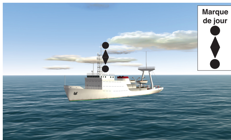
1.3.8.F. — Navire à capacité de manœuvre restreinte avec ou sans erre - Marque de jour (Règle 27 b-ii).
